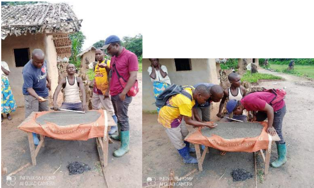
Photos 22 à 27 : Extraction du concentré dans le cours d'eau, séchage et séparation manuelle du sable de la monazite et de la cassitérite
