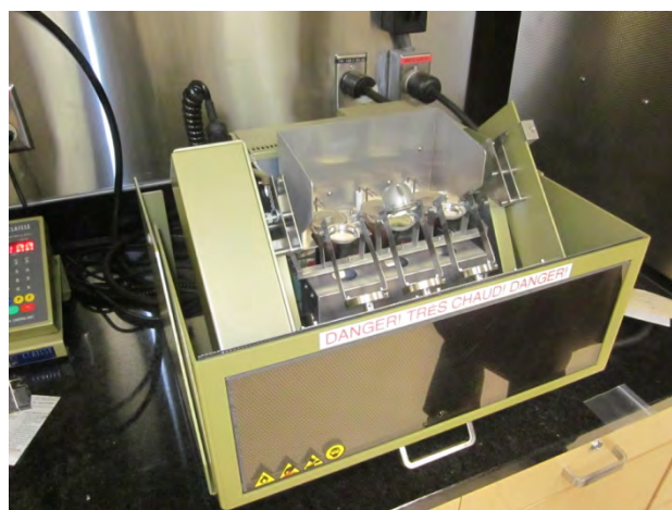
Photo #06 – Fluxeur Claisse M4-30 Gas fusion
