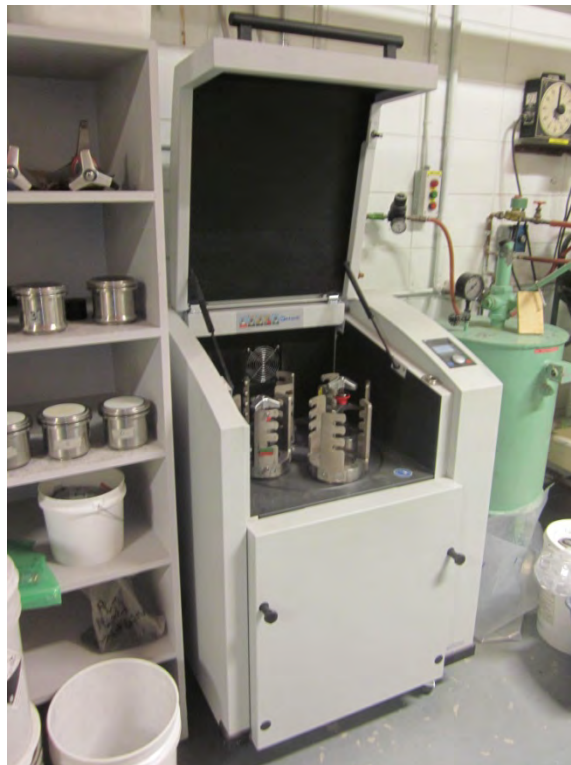
Photo #04 – Pulvérisateur Retsch
