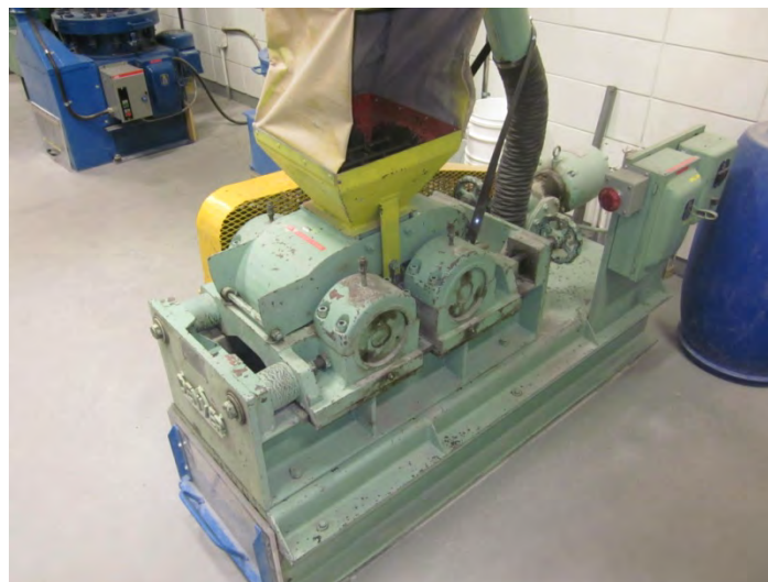
Photo #03 – Concasseur à rouleaux Denver
