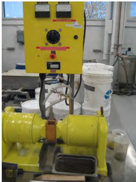
Photo #15 – Séparateur magnétique WHIMS
