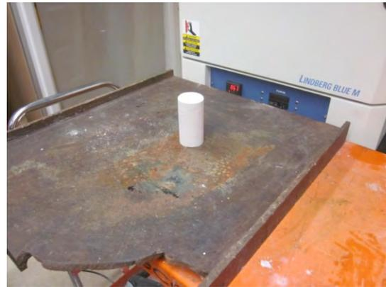
Photo #22 –Échantillon section de carotte en refroidissement
