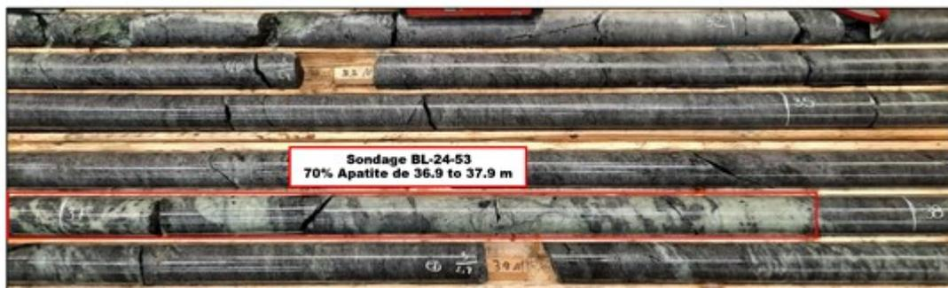
**Figure 1 - Veine à 70% d'apatite sur 1,0 mètre dans le sondage BL-24-53**
