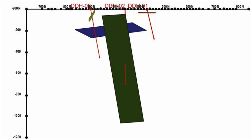
Vue en section (regard vers l'est) on constate la continuité en profondeur du conducteur EM-03 en vert, dépassant les 800 mètres.
