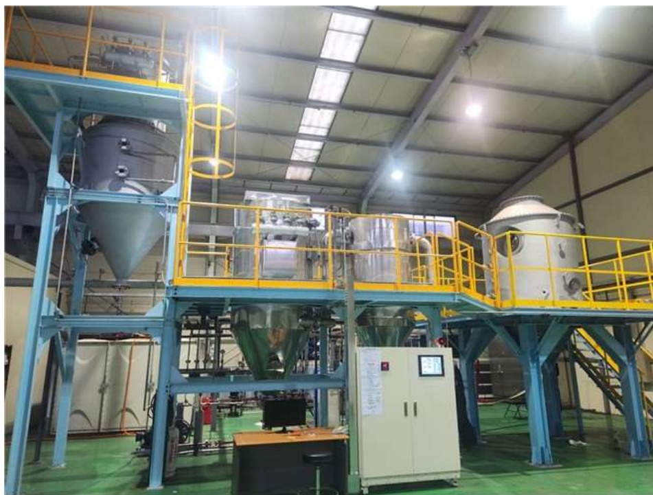
Sur cette photo : Vue partielle de certains cyclones et du réacteur de l'usine pilote de production d'hydrogène de 75 kW.
